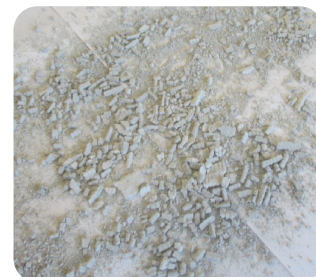
④ウェーブネットからセメントモルタルを分離
